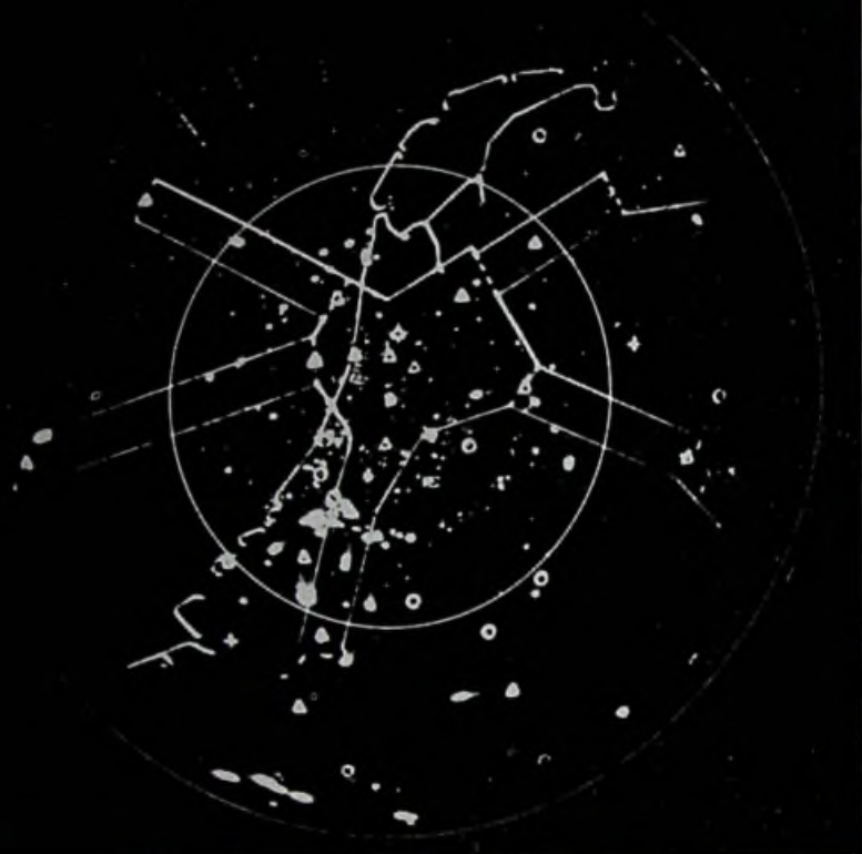
Afb. 6 Beeld van de lange afstand radar (LAR). De contouren en luchtwegen worden langs optische weg op het beeldscherm geprojecteerd.
